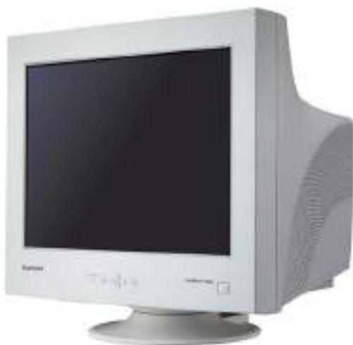
Рис. 21 CRT монитор
