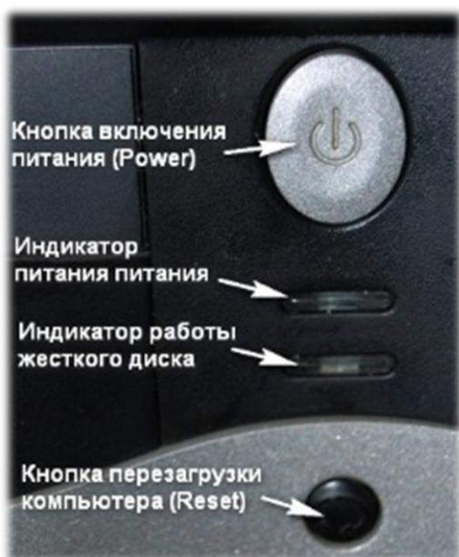
Рис. 19 Кнопки на передней панели
