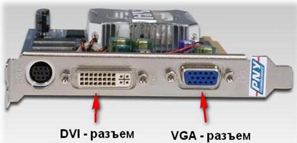
Рис. 36 Разъемы DVI и VGA
